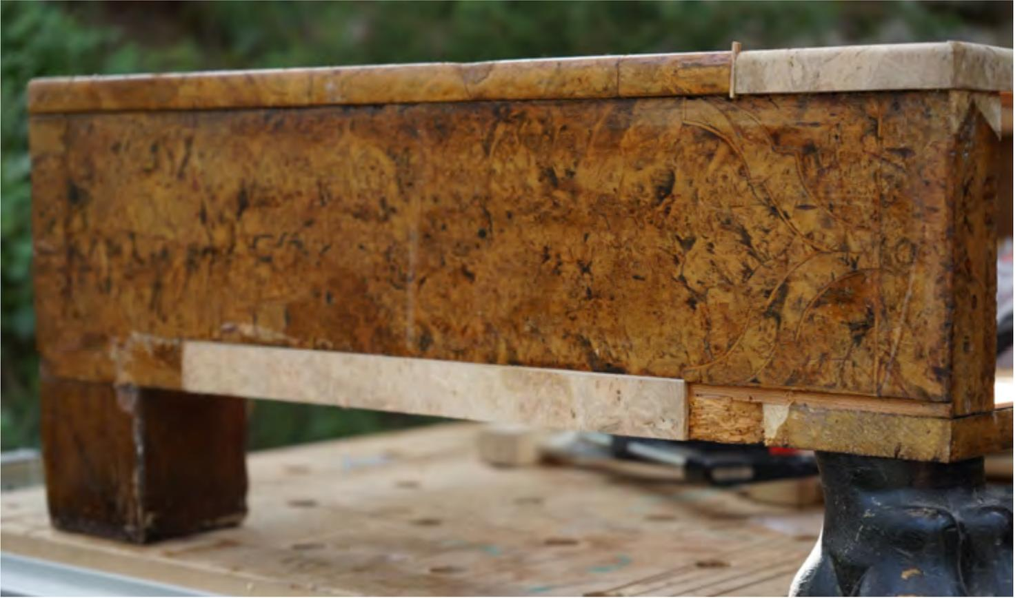
S.19: Die im Sockel geleimten Funierstücke werden zum Trocknen gezwängt. Oben: Das neu eingesetzte Funier. Unten (links): Vor der
