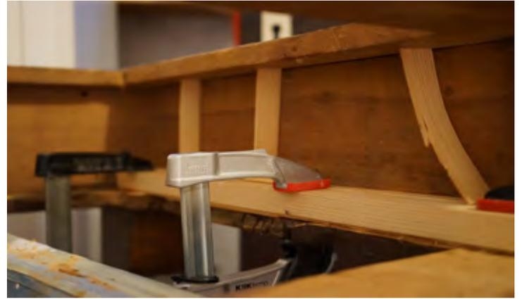
Links: Die Innenseite des Sockels der Kommode. Rechts: Anleimung der Laufschiene mit Hasenleim im Laufkasten.
