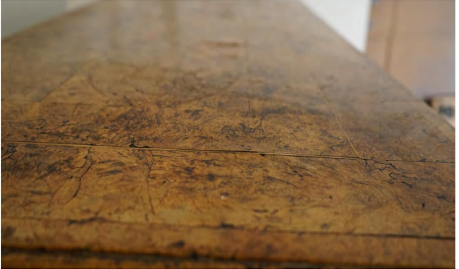
Oben und unten: Das Deckblatt der Kommode. Unten: Fehlstellen und Abplatzungen im Deckfurnier.
