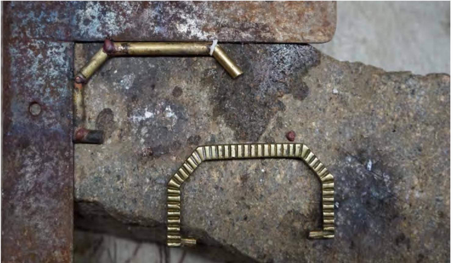
Oben: Die Anfertigung des Messinggriffs. Unten (links) Der fertige Griff und die gesäuberten Messingverbindungen.
