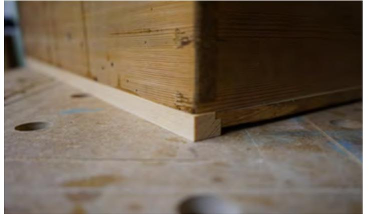
Links:: die geleimte Führungsleiste. Rechts: Die neu eingepasste Leiste.
