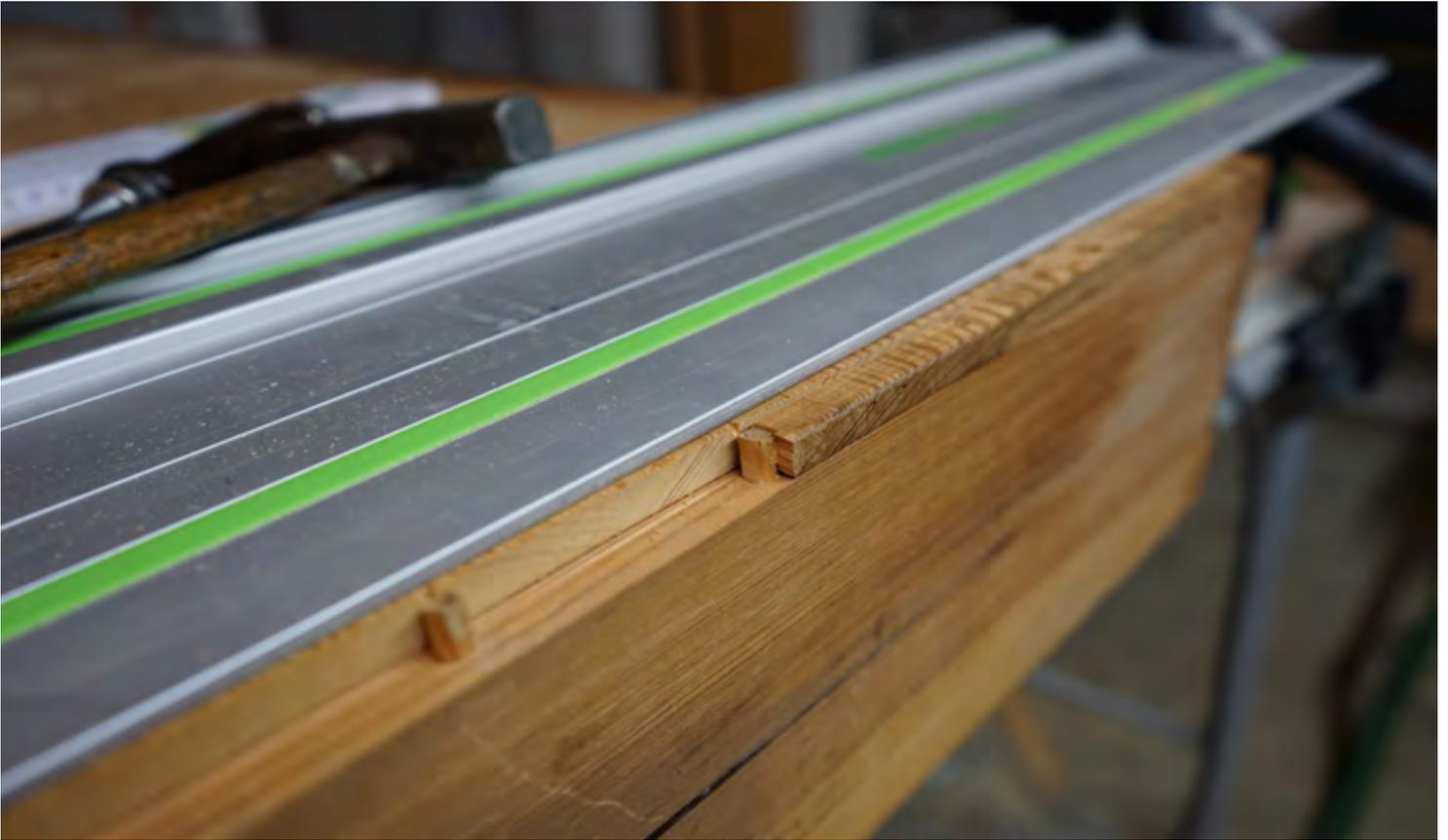
Oben und unten: Das fehlende Stück des Schubkastens wird bündig mit Handkreissäge eingeschnitten.
