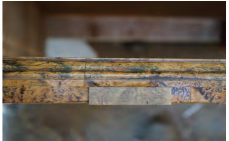
der Maserung zu dem umgebenden Funier passt, wird eingesetzt.
