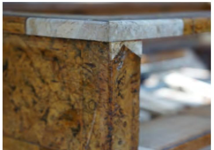
Unten (rechts): Die neue Funier ist fest verleimt und wird nun durchs Schleifen der Überstände vollständig eingepasst.
