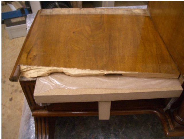
Abbildung 7: Bruchstelle am Deckblatt
