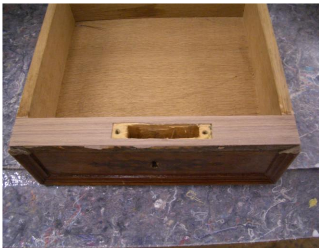
Abbildung 3: Schubkasten Furnier erneuert
